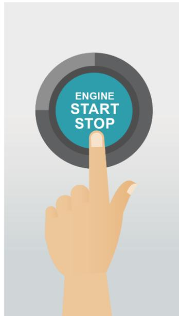
シフトレバーがPの状態、ブレーキペダルをしっかりと踏み込み、「エンジン スタート ストップ」スイッチを押します
